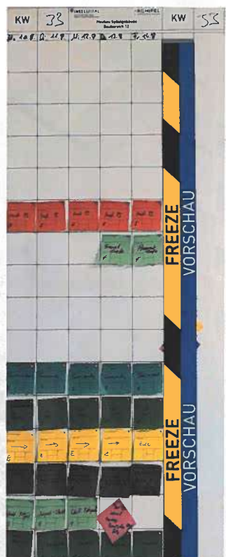
Bei der wöchentlichen Produktionsplanung sind den einzelnen Gewerken jeweils Farben zugeordnet, was die Übersichtlichkeit erhöht.
